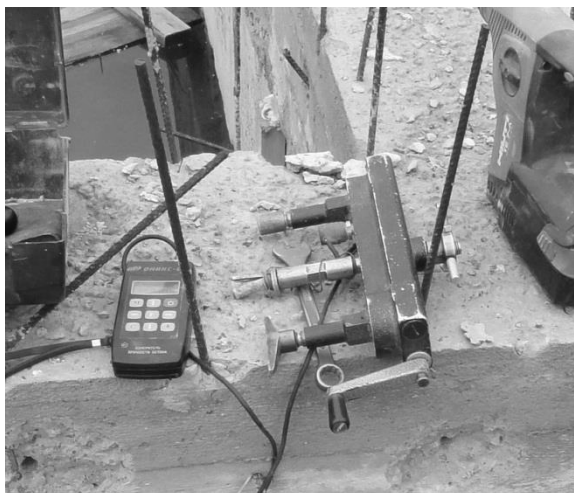
Рис. 11.2. Определение прочности бетона методом отрыва со скалыванием при помощи прибора «ОНИКС-ОС»: а – прибор «ОНИКС-ОС»; б – процесс выполнения работ на площадке
