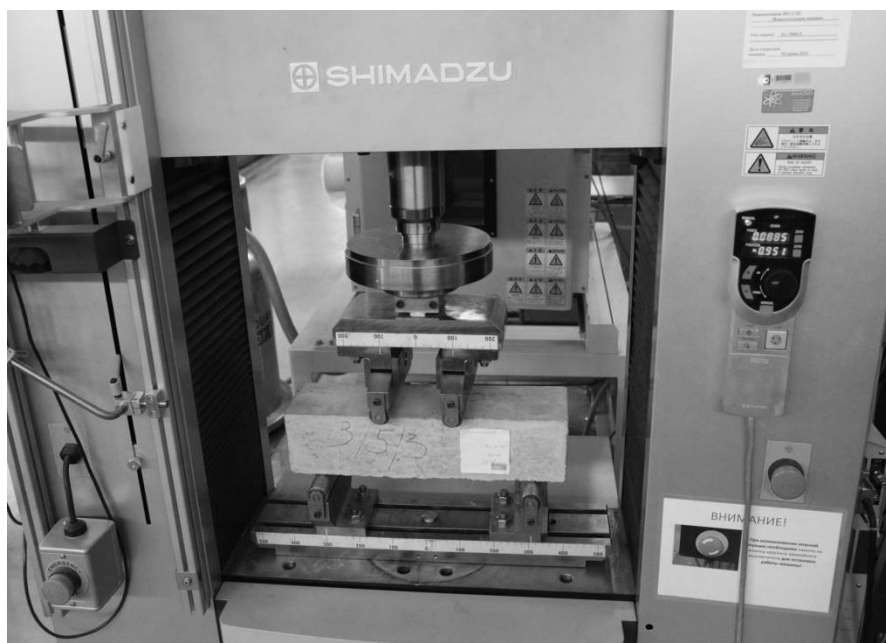
Рис. 9.10. Испытание бетонных образцов на растяжение при изгибе на универсальной испытательной машине AGX-300kN (Шимадзу, Япония) с использованием штатных приспособлений
