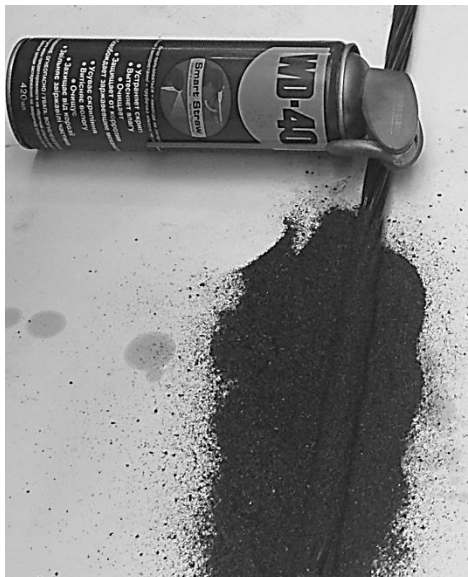
Рис. 4.4. Обеспечение дополнительного трения на концах образца
