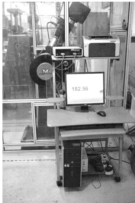
Рис. 5.18. Значение работы удара, полученное при помощи автоматического маятникового копра SI-1M
