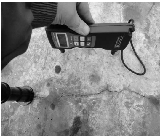
Рис. 11.11. Определение глубины трещины методом поверхностного прозвучивания при помощи прибора УК1401: а – прозвучивание сплошного бетона; б – прозвучивание бетона, имеющего трещину
