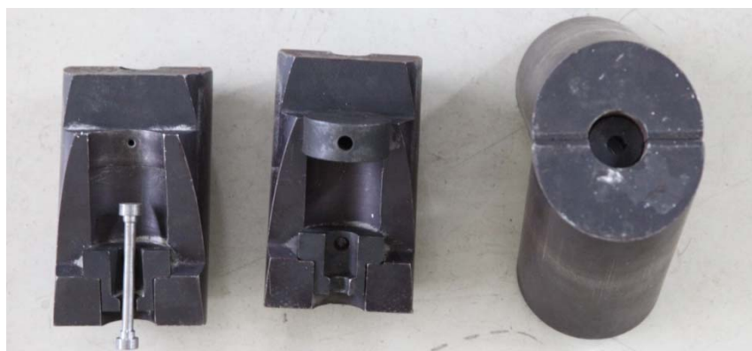
Рис. 5.6. Инвентарные губки с установленными вкладышами для машины МИРИ-500К для испытаний пропорциональных цилиндрических образцов
