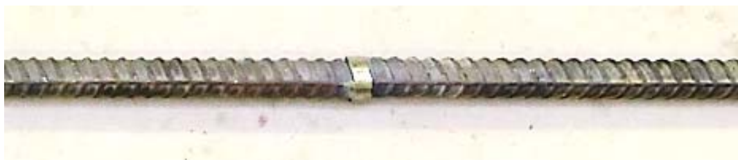
Рис. 2.1. Стыковая сварка отдельных арматурных стержней
