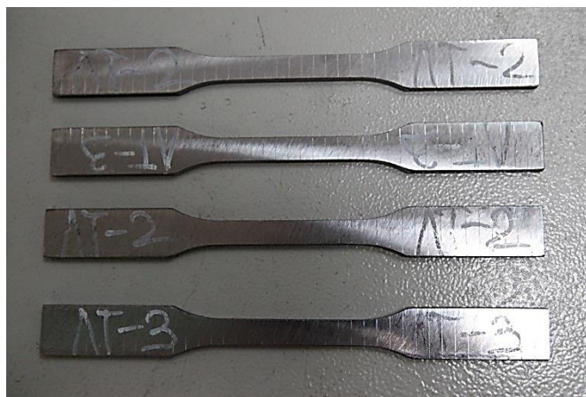
Рис. 5.7. Разметка плоских образцов: а – делительная машинка; б – образцы с нанесенными рисками
