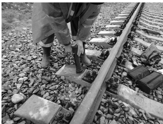
Рис. 11.8. Определение прочности бетона методом пластической деформации: а – проведение испытаний; б – отпечаток на бетонной поверхности
