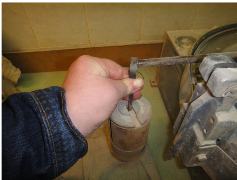
Рис. 9.17. Испытания на истираемость: приложение сосредоточенной вертикальной нагрузки
