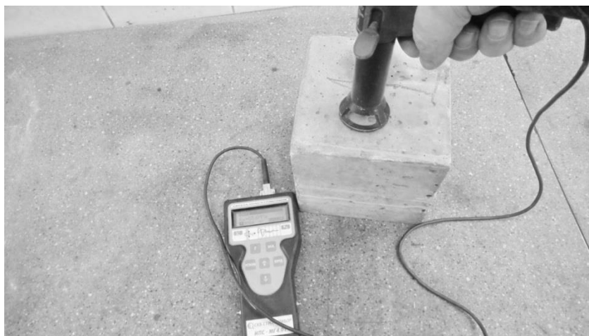
Рис. 11.9. Определение прочности бетона методом ударного импульса при помощи прибора ИПС-МГ4 производства фирмы «СКБ Стройприбор»
