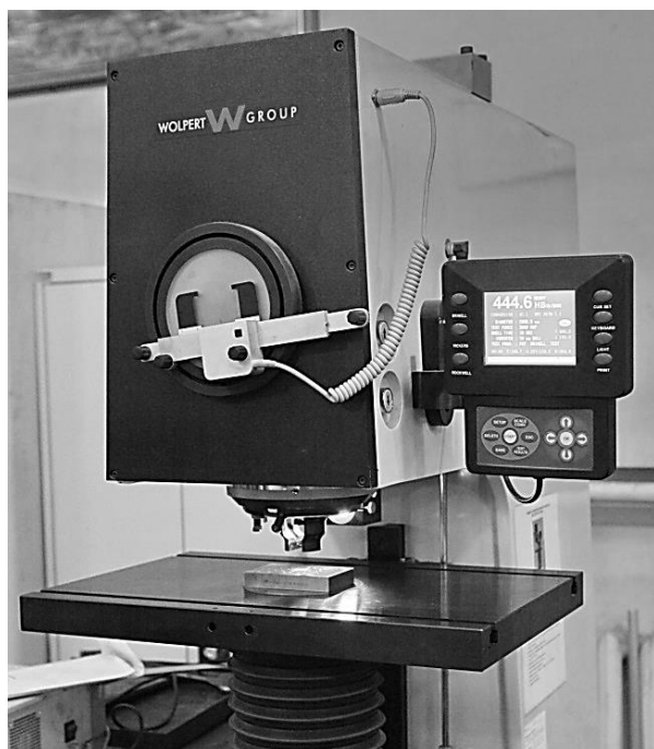
Рис. 5.24. Определение твердости образца по методу Бринелля на универсальном твердомере DIGI-TESTOR 971/3000D: а – общий вид твердомера; б – монитор с результатами испытаний 445 HB 10/3000 (или 445 HB)
