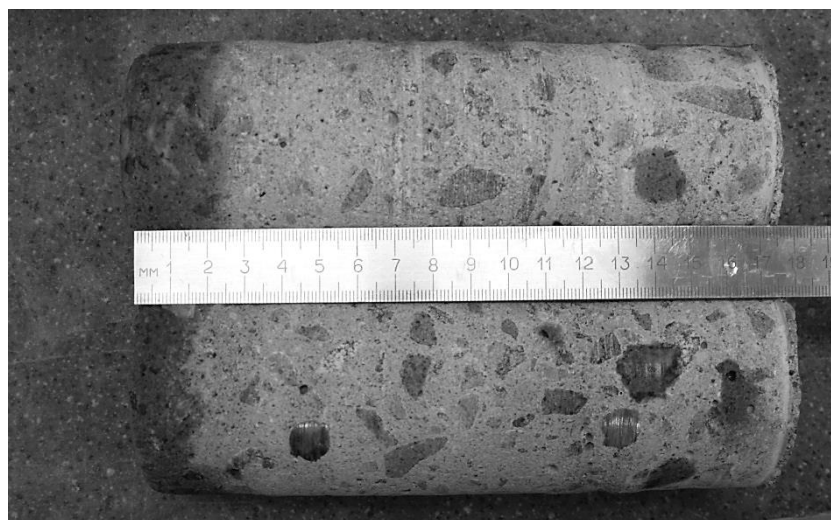
Рис. 12.2. Отобранные пробы бетона (керны)
