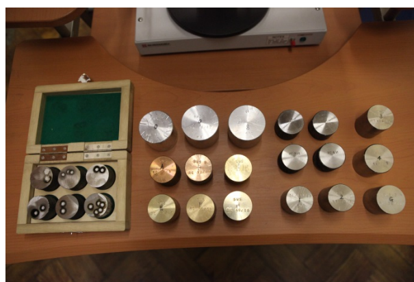
Рис.1.2. Определение химического состава стали: а – рабочая зона эмиссионного спектрометра PDA-7000; б – набор стандартных образцов
