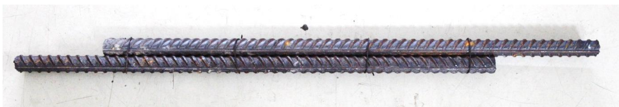
Рис. 3.1. Механические соединения арматуры, выполненные с помощью: а – обжимных муфт (до и после испытаний); б – резьбовых муфт (муфтовое соединение и отдельно арматура с нарезанной конической резьбой); в – нахлесточного соединения
