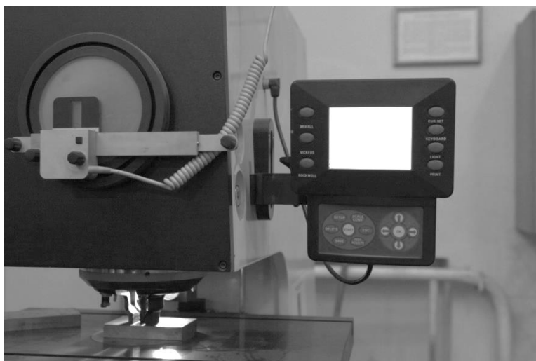
Рис. 5.22. Определение твердости образца по методу Бринелля на универсальном твердомере DIGI-TESTOR 971/3000D производства компании Instron Wolpert Wilson Instruments (Великобритания): процесс нагружения
