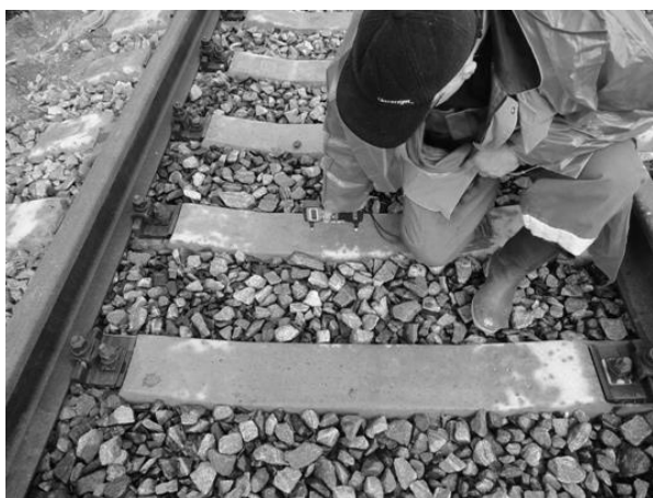
Рис. 11.10. Определение прочности бетона ультразвуковым методом при помощи прибора УК1401
