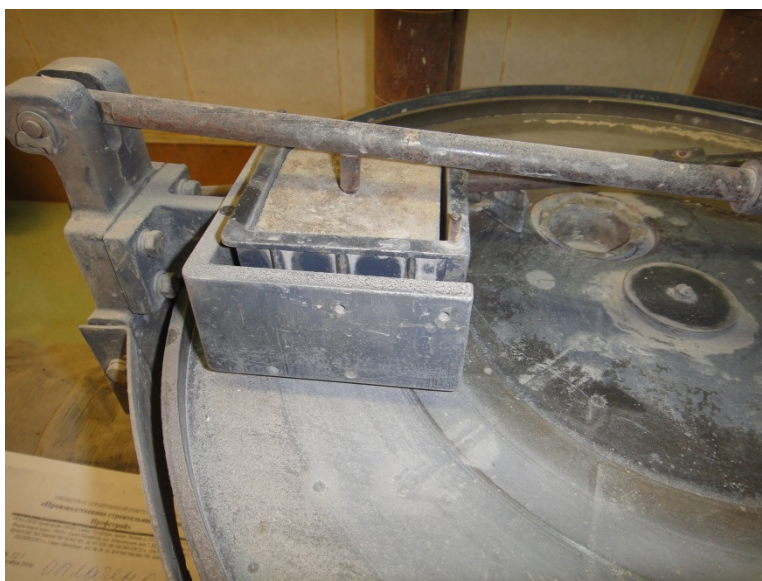
Рис. 9.16. Испытания на истираемость бетона: образец установлен в специальном гнезде
