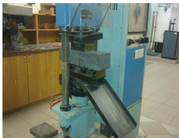
Рис. 9.9. Испытания бетонных образцов на растяжение при изгибе: а – приспособление для испытаний; б – проведение испытаний на прессе МС-100
