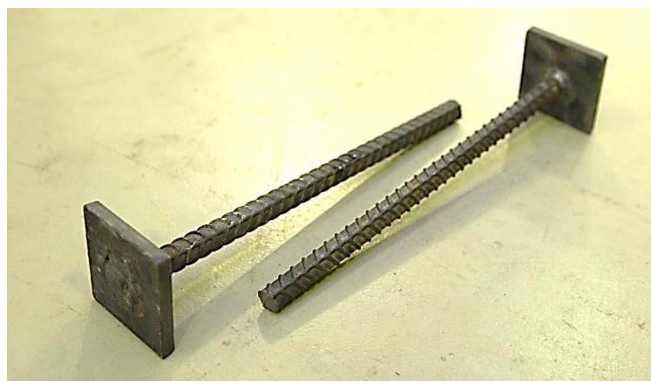
Рис. 2.4. Образец таврового сварного соединения, вырезанный из закладной детали открытого типа с параллельным расположением анкерных стержней
