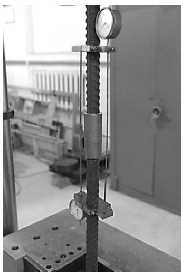
Рис. 3.2. Определение деформативности механического соединения арматуры
