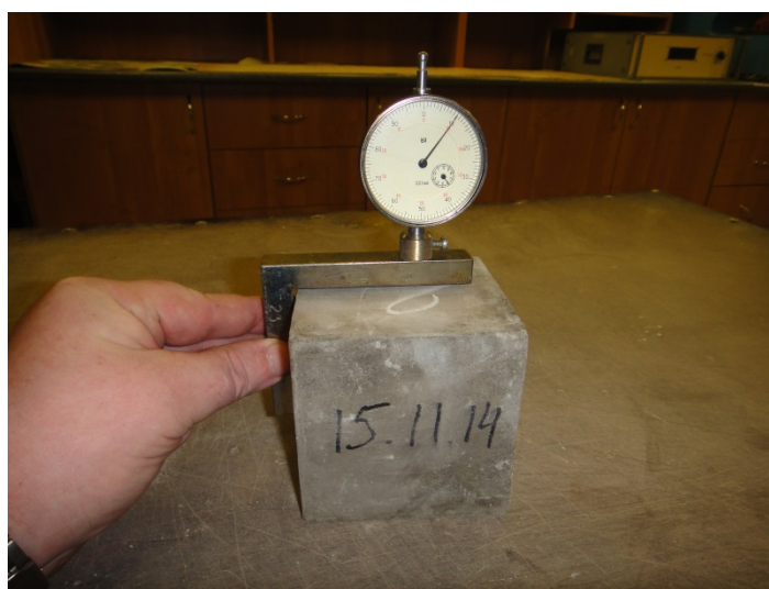
Рис. 9.2. Определение отклонения от перпендикулярности смежных граней образца-куба при помощи прибора НПР-1
