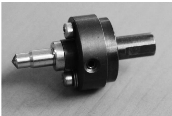
Рис. 5.26. Инденторы для твердомера DIGI-TESTOR 971/3000D для определения твердости по методу Роквелла: а – алмазный конусный наконечник; б – шариковый стальной наконечник
