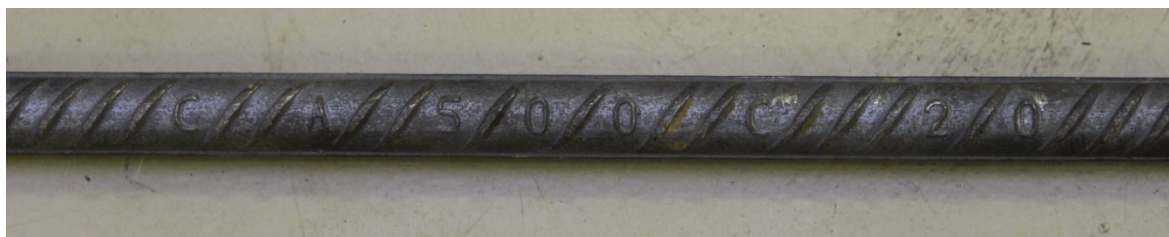
Рис. 1.1. Пример прокатной маркировки арматуры класса А500С диаметром 20 мм
