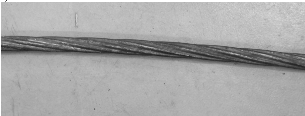
Рис. 4.1. Конструкция каната 1 х 7 (а) и его внешний вид (б, в)
