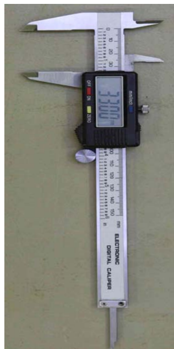
Рис. 7.3. Штангенциркуль типа ШЦ-1 с опорой: 1 – штангенциркуль; 2 – опора
