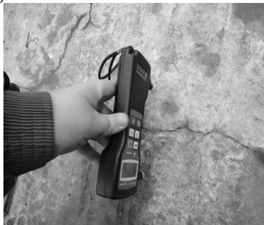
Рис. 11.11. Определение глубины трещины методом поверхностного прозвучивания при помощи прибора УК1401: а – прозвучивание сплошного бетона; б – прозвучивание бетона, имеющего трещину
