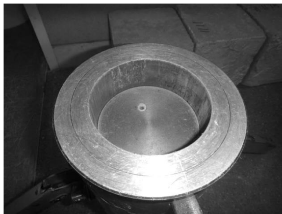
Рис. 10.6. Определение воздухопроницаемости бетона: а – проведение испытаний прибором «Агама-2Р»; б – вид сверху (крупно)
