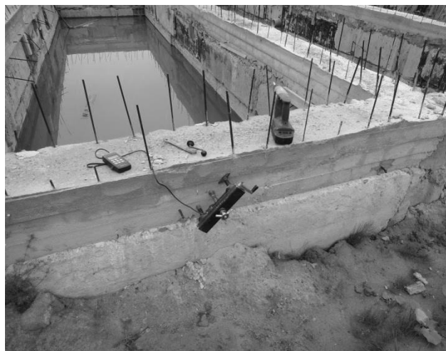
Рис. 11.2. Определение прочности бетона методом отрыва со скалыванием при помощи прибора «ОНИКС-ОС»: а – прибор «ОНИКС-ОС»; б – процесс выполнения работ на площадке
