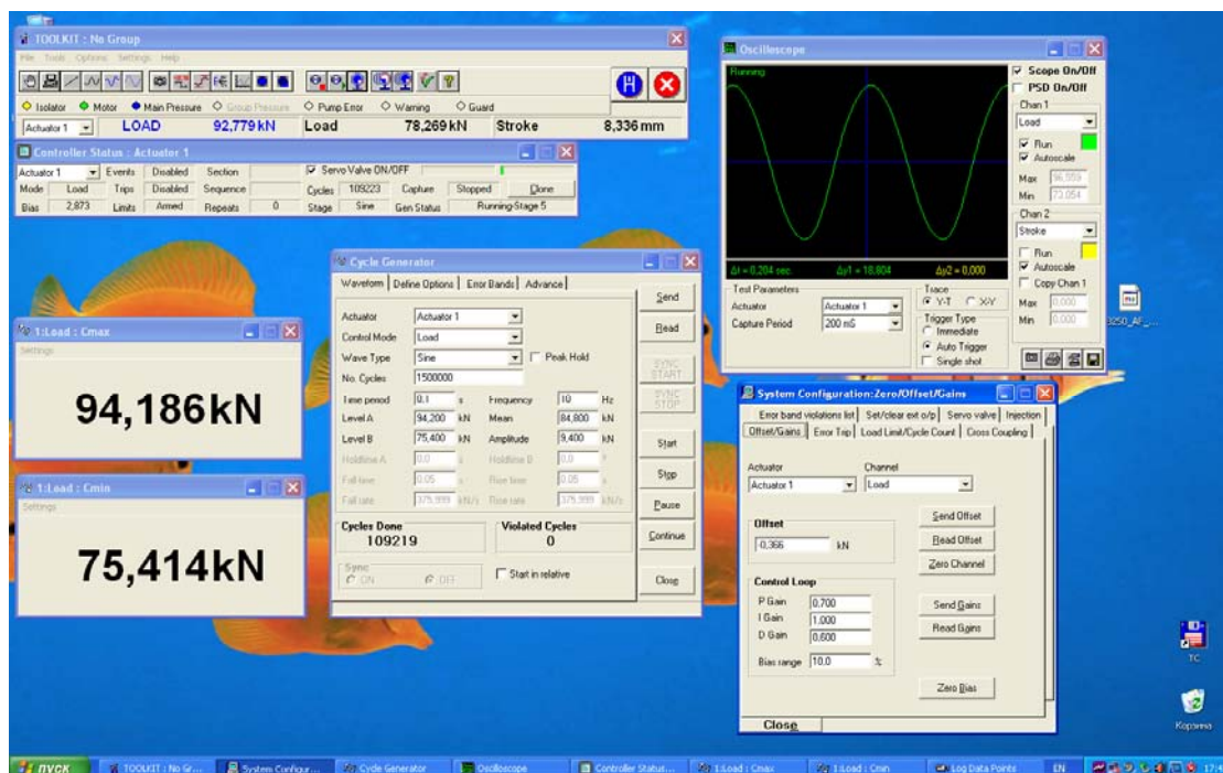
Рис. 3.4. Экран монитора управляющей системы пульсатора Amsler HB 250 при испытаниях механических соединений арматуры на выносливость с заданием цикла по силе со следующими параметрами: максимальная нагрузка 94,186 кН; минимальная нагрузка 75,414 кН, частота 10 Гц
