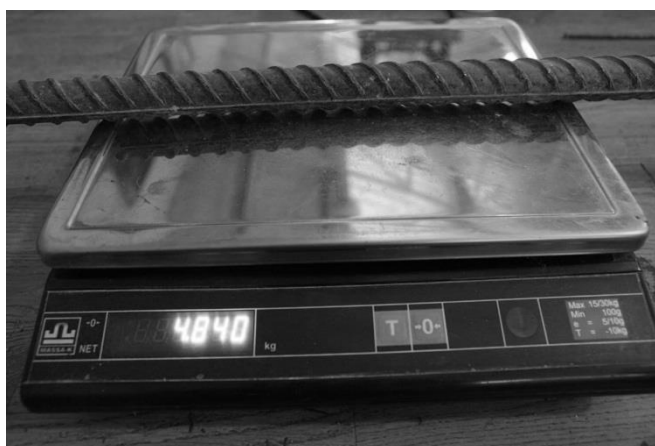
Рис. 1.3. Определение номинальной площади поперечного сечения образца арматуры: а – определение длины образца; б – определение массы образца
