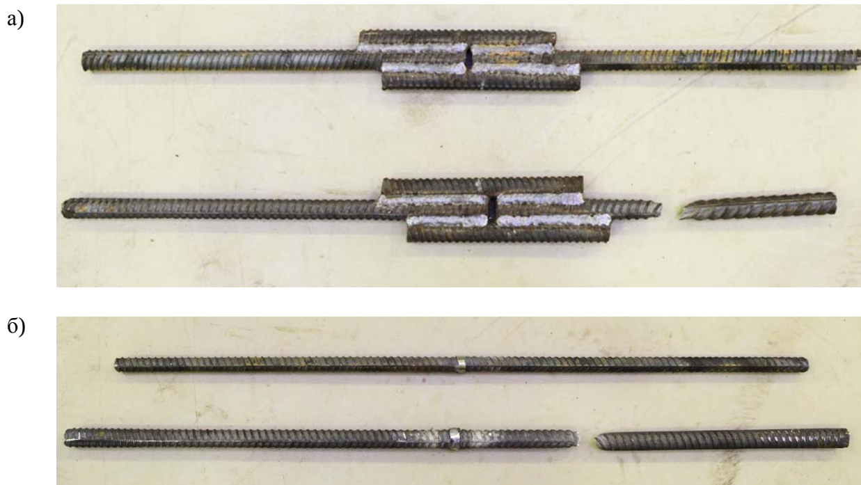
Рис. 2.5. Сварные образцы до и после испытаний на растяжение
