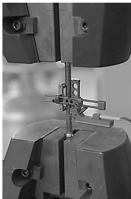
Рис. 5.9. Определение модуля упругости при помощи навесного экстензометра
