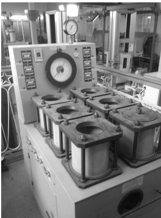
Рис. 10.1. Установка УВФ-6 для определения водонепроницаемости бетона
