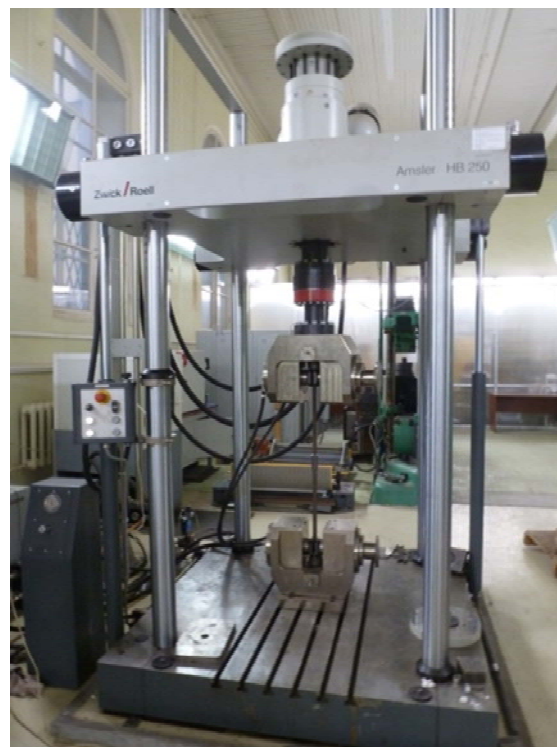
Рис. 3.3. Проведение испытаний на выносливость муфтовых механических соединений арматурных стержней
