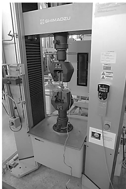
Рис. 5.9. Определение модуля упругости при помощи навесного экстензометра
