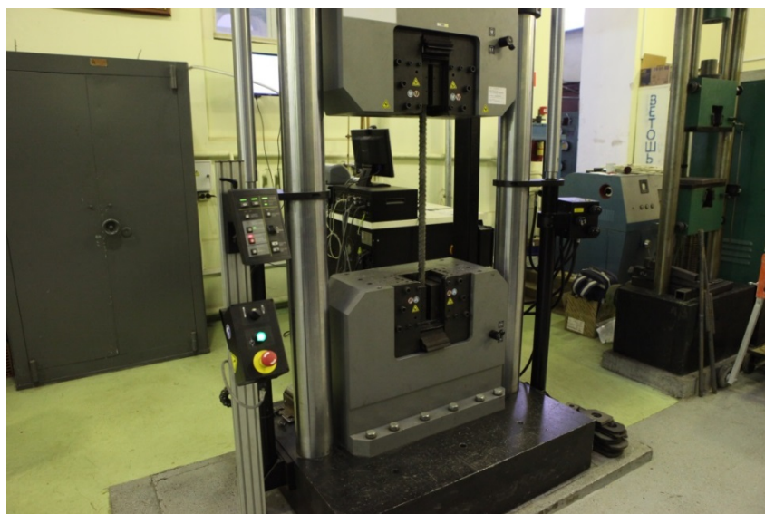
Рис. 1.5. Испытания арматуры на растяжение на машине Instron SATC 1200KN: а – общий вид; б – образец после разрыва
