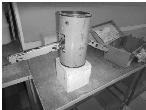
Рис. 10.6. Определение воздухопроницаемости бетона: а – проведение испытаний прибором «Агама-2Р»; б – вид сверху (крупно)
