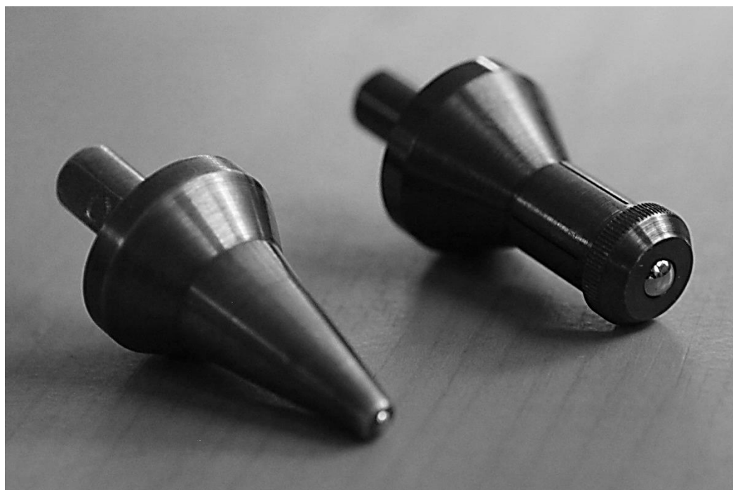
Рис. 5.21. Инденторы твердомера DIGI-TESTOR 971/3000D для измерения твердости по методу Бринелля с шариками диаметром 2,5 мм (слева) и 5 мм (справа)
