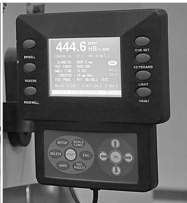
Рис. 5.24. Определение твердости образца по методу Бринелля на универсальном твердомере DIGI-TESTOR 971/3000D: а – общий вид твердомера; б – монитор с результатами испытаний 445 HB 10/3000 (или 445 HB)
