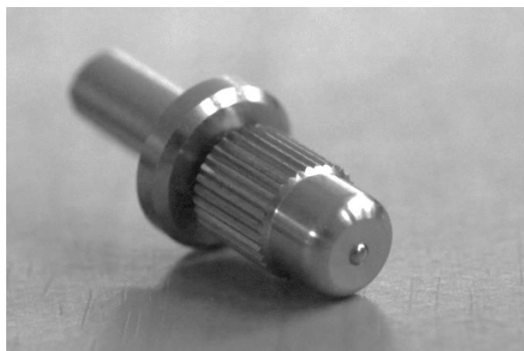
Рис. 5.26. Инденторы для твердомера DIGI-TESTOR 971/3000D для определения твердости по методу Роквелла: а – алмазный конусный наконечник; б – шариковый стальной наконечник
