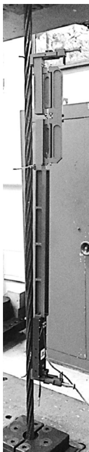
Рис. 4.2. Испытание арматурного семипровлочного каната на машине SATC 1200KN-J3D: а – установка экстензометра; б – общий вид установки
