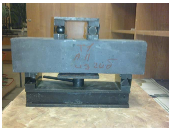
Рис. 9.9. Испытания бетонных образцов на растяжение при изгибе: а – приспособление для испытаний; б – проведение испытаний на прессе МС-100
