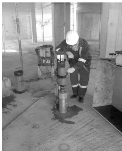
Рис. 10.4 Отбор образцов-цилиндров диаметром 150 мм из железобетонной плиты: а – процесс выбуривания; б – оборудование для выбуривания – бурильная машинка производства компании Hilti
