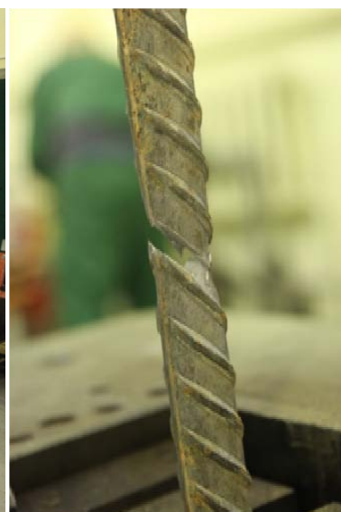
Рис. 1.5. Испытания арматуры на растяжение на машине Instron SATC 1200KN: а – общий вид; б – образец после разрыва
