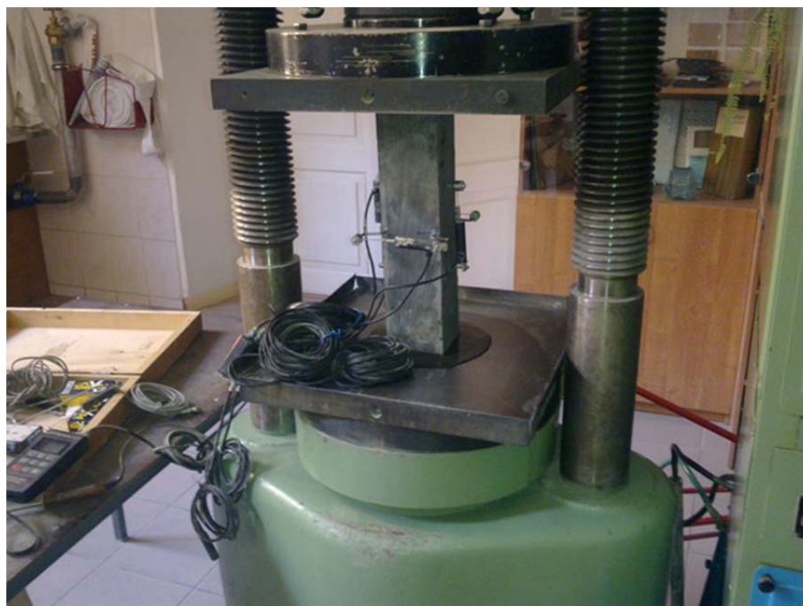
Рис. 9.14. Определение призмной прочности, модуля упругости и коэффициента Пуассона: а – образец-призма с установленными на нем датчиками деформаций от прибора «Терем»; б – процесс проведения испытаний на прессе
