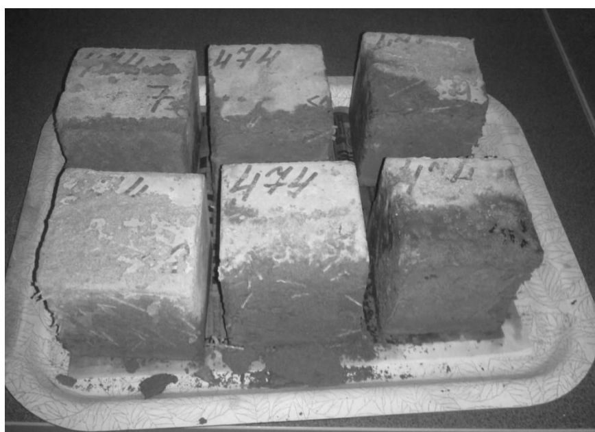
Рис. 10.8. Основные образцы-кубы после проведения заданного числа циклов замораживания и оттаивания
